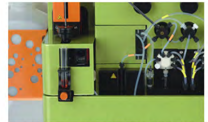
图 10: MACSQuant配备MACSQuant富集单元可以在流式分析之前稀有细胞的直接高灵敏预富集。
