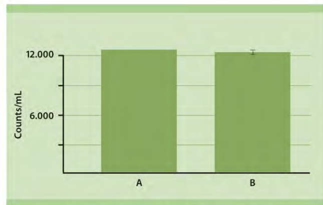
图 7: 绝对细胞计数是精确的，可重复的。计数微珠可以在MACSQuant上检测，和微珠厂家发布的信息进行比较。厂家数据报告的每ml微珠数显示在A，5管计数微珠在MACSQuant上检测，5管的平均体积进行计算(B)，MACSQuant上的计数和厂家报告的数量并没有区别。(误差线：标准偏差)
