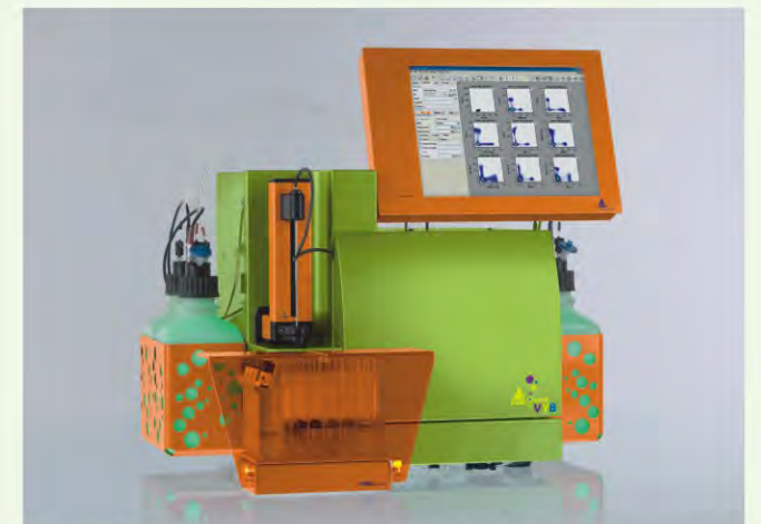
图 4: MACSQuant VYB 整合561nm激光可以提供荧光蛋白和常用抗体的复杂分析。
