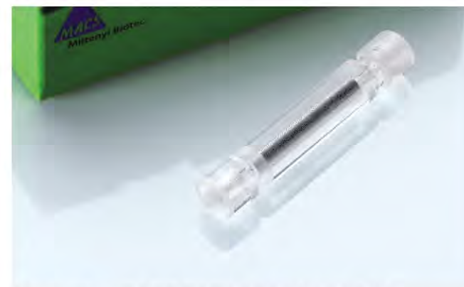
图 9: MACSQuant柱允许流式分析之前稀有细胞的快速预富集
