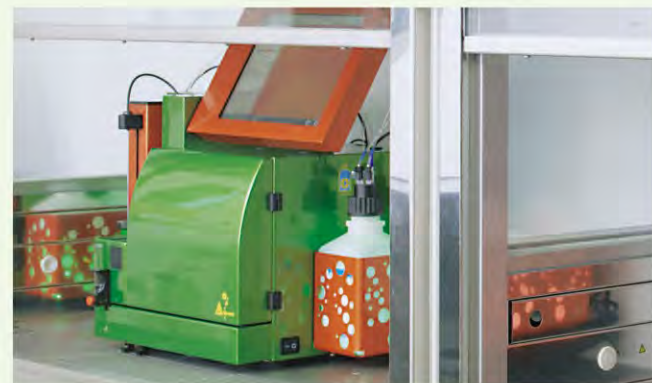
图 2: MACSQuant 流式细胞仪能在有限的实验空间，甚至常规的层流室进行检测
