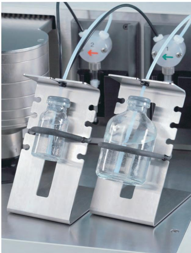
**Orion II**是目前同级别仪器中唯一既可以行模式也可以列模式进行最高速循环的化学发光检测仪。优秀的系统设计使得加样泵到微孔板孔间的距离最小化，从而最大程度地减少了系统残余，节约所使用的试剂。其系统残余小于450 μl，是目前市场上所有板式化学发光仪中最少的。
